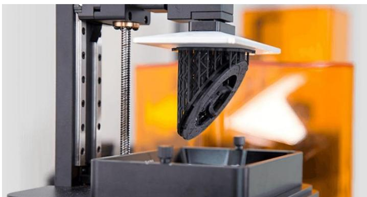
Les technologies **SLA** et le **DLP** sont deux technologies d'impression 3D résine traditionnelles utilisant des procédés différents pour durcir la résine. Avec le SLA, la résine est durcie à l'aide d'un laser, la précision est constante, mais la vitesse d'impression est proportionnelle à la quantité de l'espace de travail occupé par les modèles. Avec la technologie DLP, la vitesse d'opération ne dépend que de l'axe z (la hauteur des objets) car la résine est
